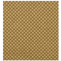
Fibra de Aramida Kevlar™ Synth, fibra de poliamida tejida o sin tejer, unidireccional.
