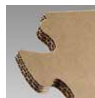
Cartón ondulado Doble o triple canal, y materiales gruesos a base de cartón
